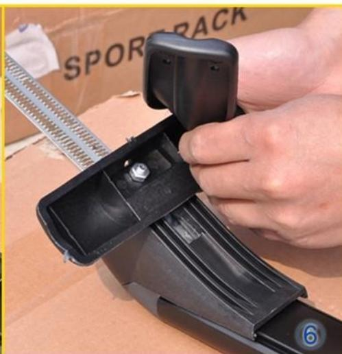
安装第六步：盖上橡胶护垫。
