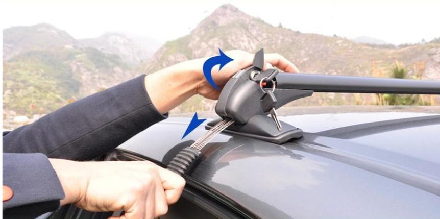
第五步：扳动锁把头至合拢位置，然后拉出钢片卡条，拆卸完成。(如图演示)
