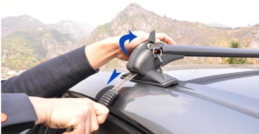
第五步：扳动锁把头至合拢位置，然后拉出钢片卡条，拆卸完成。(如图演示)
