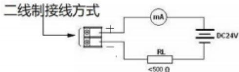
防爆分体式接线法：POWER：接DC24V电源正负极；
